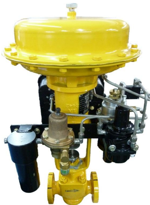
Fig. 2: Sistema de bloqueo por incremento de presión que incluye válvula de control 667 ET (NC), controlador neumático 4150-S ("snap action"), filtro 254E, regulador 1301F, regulador 67FR y relay 168A.
