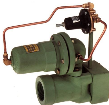
Fig. 4: Regulador TIPO 631 VÁLVULA REGULADORA REDUCTORA, CARGADA CON PRESIÓN, RESORTE PARA EL CIERRE. NORMALMENTE CERRADA. PILOTOS DE APLICACIÓN TIPO 67, 67H, 1301F Y 1301G.
